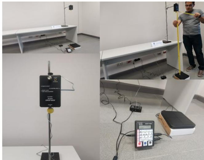
Figura 3. Diseño de grabación del LU de caída libre. Fuente: Elaboración propia.
