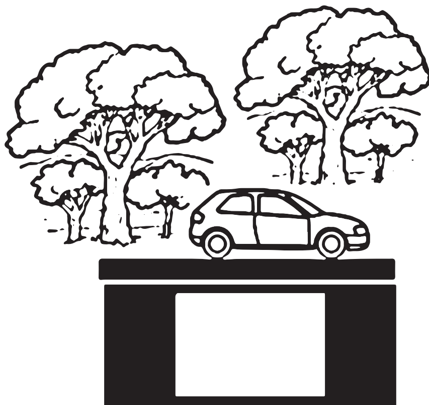
Figura 3. Pasa-faunas subterráneos recomendados principalmente para armadillos.
