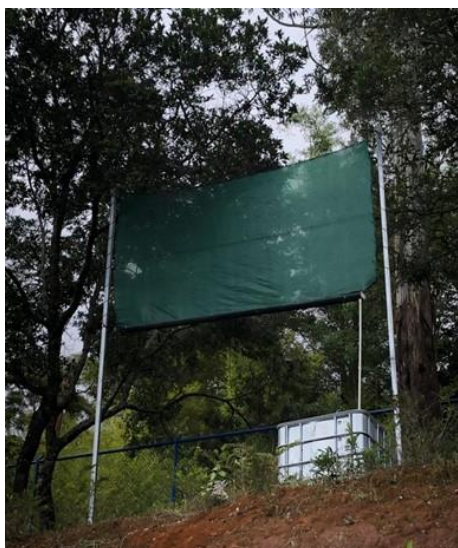
Figura 3. Atrapanieblas 1. Altitud Cerro Trinidad, San Marcos de Tarrazú: 1700 m.s.n.m.
