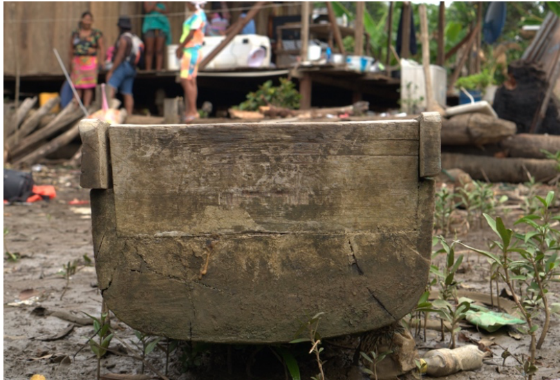
Figura 13. Modificación a la plataforma tradicional por un espejo de popa para colocar el motor fueraborda
