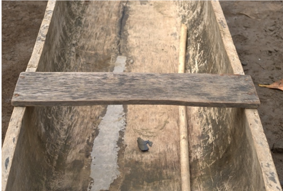
Figura 5. Barrote, asiento, jāba bugué o padú de una piragua emberá de Jaqué
